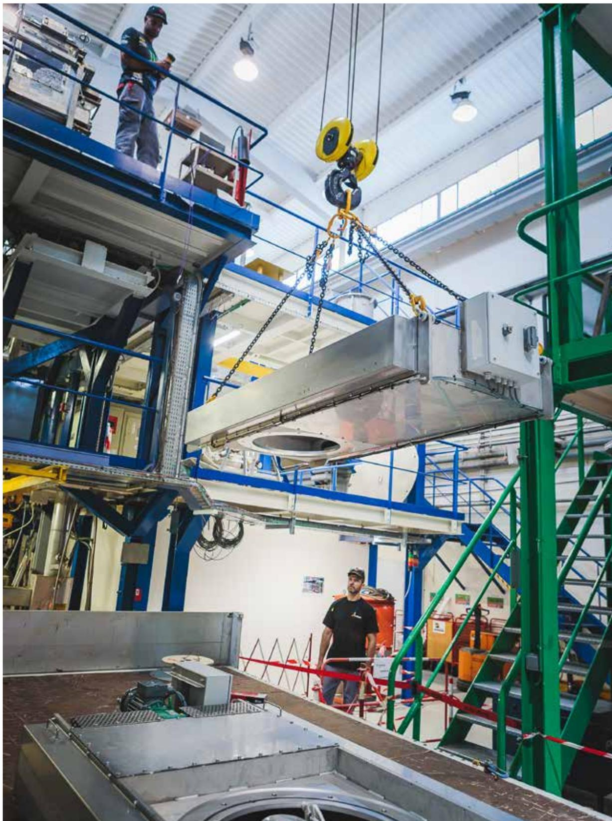
*PIVIC, prototype à l'échelle 1 pour le traitement des déchets mixtes technologiques*
